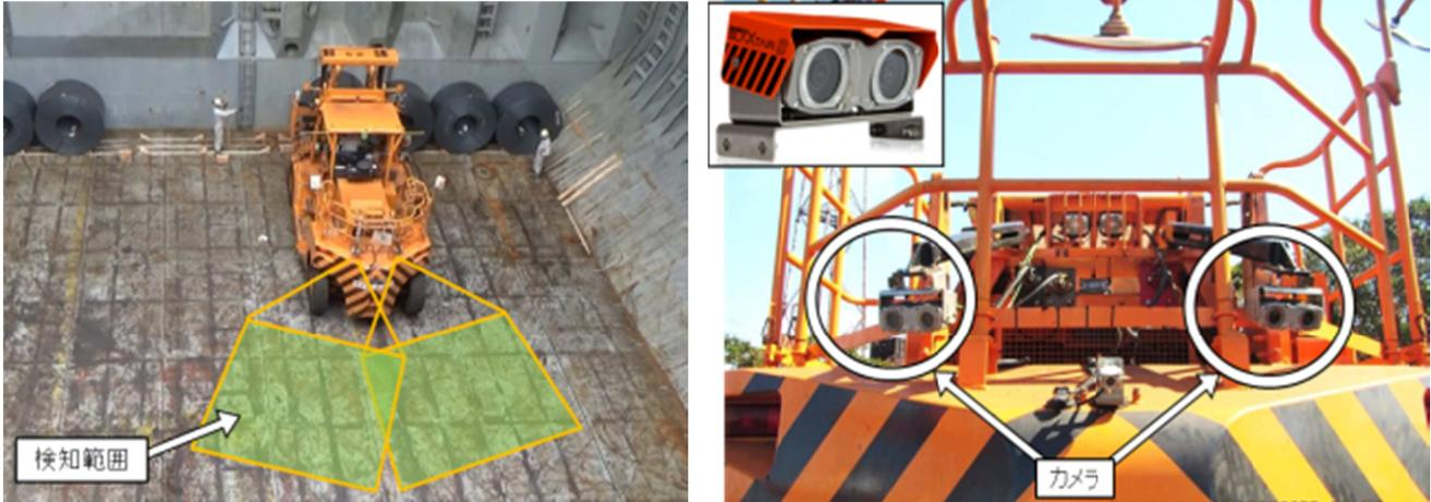
日鉄住金物流株式会社は、船艙内のフォークリフト作業における安全対策として、画像認識技術による作業者接近検知装置『ブラクステール』を実用化しました。
